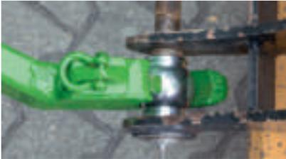
Patentierter Muffenkugel: Beim Schwenken nach rechts keine Berührung und kein Verschleiß an Haken und Anbaugerät
