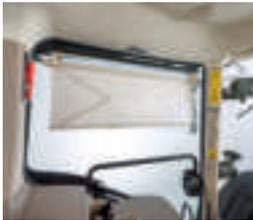
Die linke Sonnenblende ist an der Tür angebracht, sodass sie beim Zugang zur Kabine nicht bewegt werden muss.
