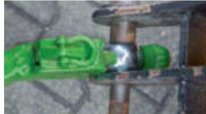
Standard-Anhängekugel Das Schwenken nach rechts führt zu Berührung und Verschleiß an Haken und Anbaugerät
